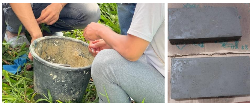
Gambar 5. Proses pendinginan bata plastik dan hasil cetakan bata plastik
